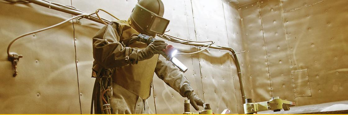
Das **Sandstrahlen** ist eine Methode der Oberflächenbehandlung eines Materials oder Werkstücks durch Einwirkung von Strahlmittel, z. B. Sand als Schleifmittel gegen Rost, Verschmutzungen, Farbe, Zunder und andere Verunreinigungen oder zur Oberflächengestaltung durch Mattierung.
