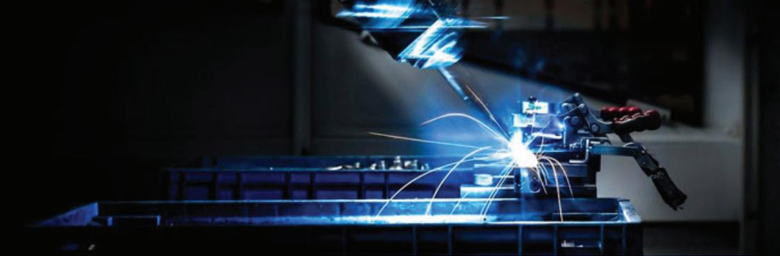
Das **Laserschweißen** wird vor allem zum Verschweißen von Bauteilen eingesetzt, die mit hoher Schweißgeschwindigkeit, schmaler und schlanker Schweißnahtform und mit geringem thermischem Verzug gefügt werden müssen.
