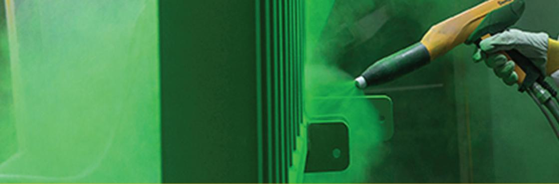
Das **Pulverbeschichten** oder die Pulverlackierung ist ein Beschichtungsverfahren, bei dem ein elektrisch leitfähiger Werkstoff mit Pulverlack beschichtet wird.
